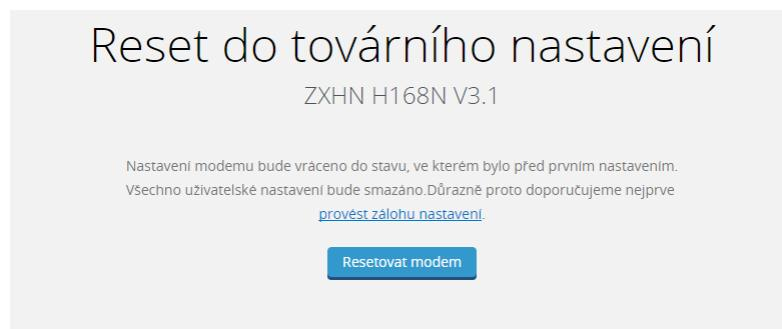
ii. Klepnutím na **Resetovat modem** obnovíte tovární nastavení.
