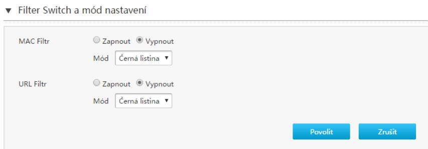
ii. Nakonfigurujte parametry Filter Switch a mód nastavení.
