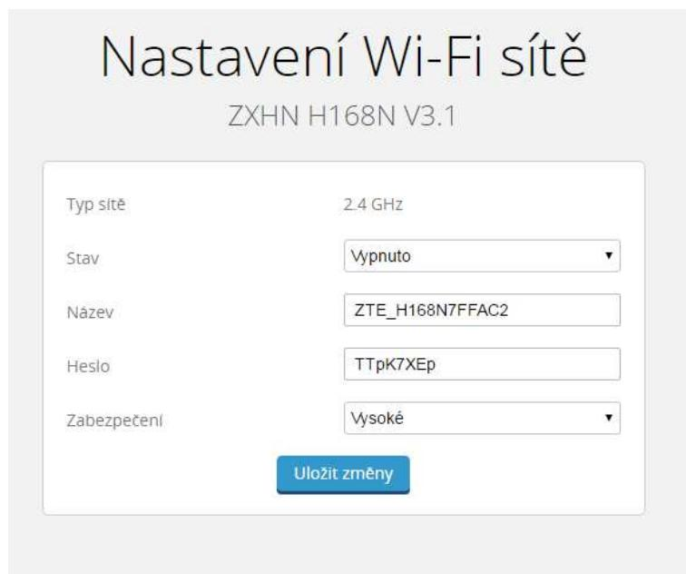
iii. Nakonfigurujte parametry bezdrátové sítě LAN. *Tabulka 5* popisuje parametry bezdrátové sítě LAN.
