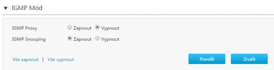
2. Klepnutím na Zapnout funkci povolíte, pomocí Vypnout zakážete.
